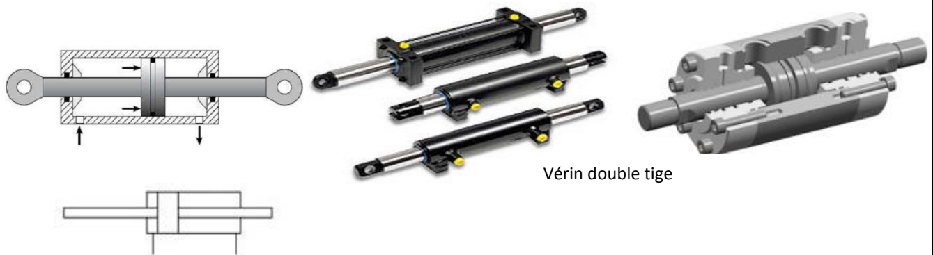
Figure 2.8 : Vérins hydrauliques à double tige.
